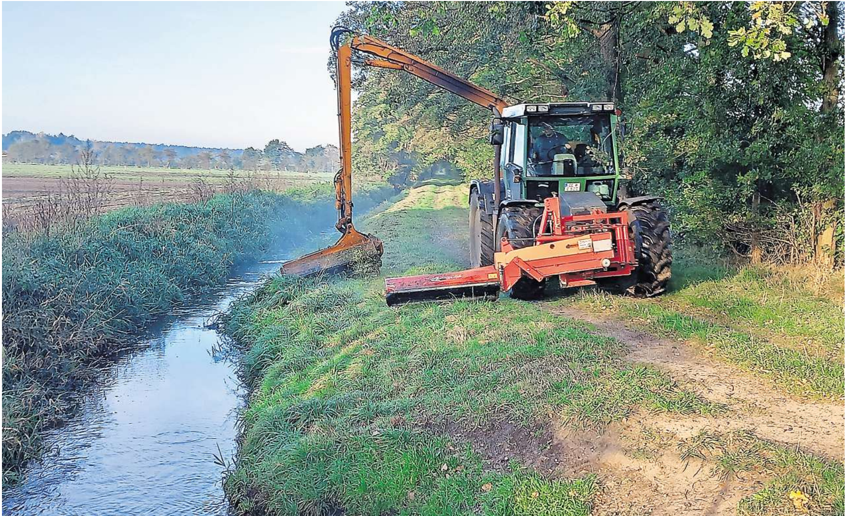
Mit einem Spezialfahrzeug lässt der Unterhaltungsverband (UV) Meißel das in die Höhe geschossene Kraut an der Oberen Drebbler schneiden. Mitte Oktober war das vormittags zwischen Waller Straße und der Verbindung zwischen Hasseler Straße und Schmalhorn der Fall. FOTO: ANDREAS BABEL
