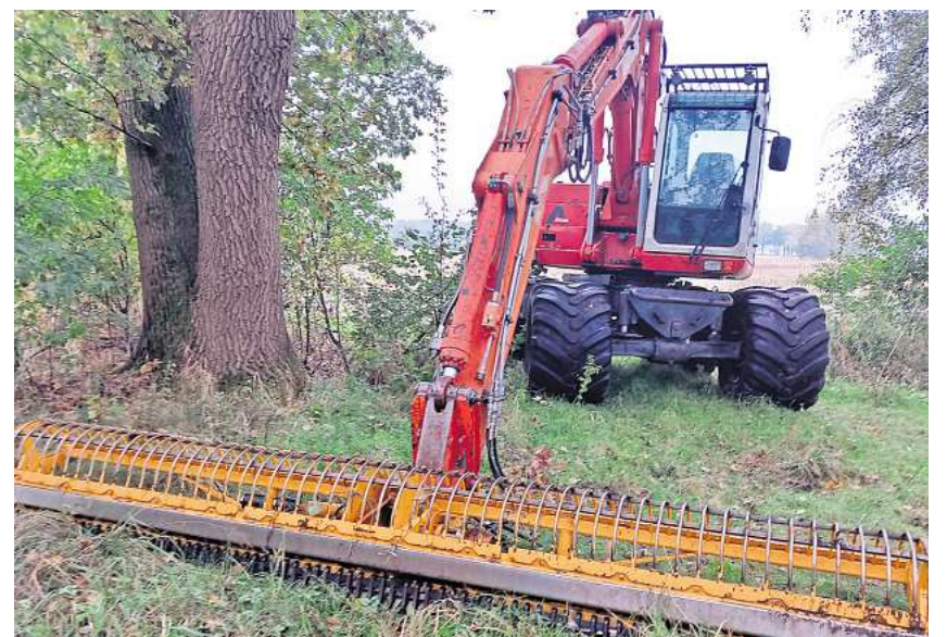
Der Bagger des Lohnunternehmens Cramm mit dem vier Meter breiten Mähkorb entnimmt auf der Gewässersohle wachsende Pflanzen dem Gewässer. An der Oberen Drebbler hatte er wenig zu tun. FOTO: ANDREAS BABEL
