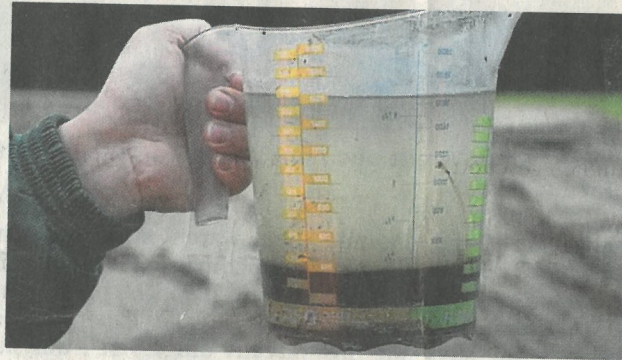
Im kleinen Maßstab: Hier sieht man, wie sich der Schlamm im Messbecher absetzt.
