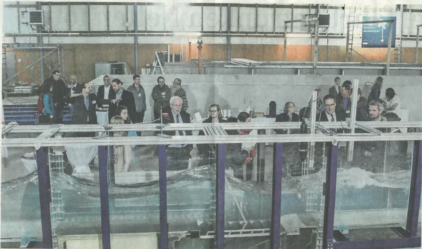
Der neue Modell-Wellenkanal misst 32 Meter. Er entspricht im Maßstab 1:10 dem Großen Wellenkanal in seiner künftigen Ausbaustufe. FOTOS: KATRIN KUTTER
